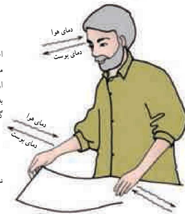
شکل ۱۳-۳- انتقال گرما از راه جابجایی
