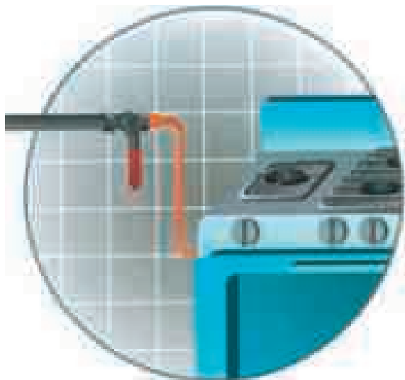
شکل ۶-۷ هنگام خاموش کردن گاز، اول شیر فلکه اصلی گاز و سپس شیر یا کلیدهای خود اجاق گاز را ببندید.
