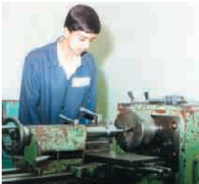
شکل ۴-۶- نمونه ای از شرایط نایمن - ماشین تراش حفاظ شفاف بر روی منطقه کاری ندارد و فرد از عینک حفاظتی استفاده نکرده است.
